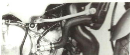
ロアカウルを外し、右側面から見たV型ラジエーターのコアをつぶさないためにも印のスターナットを左右2本を外してラジエーターをスイングさせた方が簡単かもしれない
