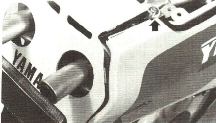
左パネルのスクリューを3本、そして写真のスクリューを2本外す。インナーパネルは左パネルに付けたままで取り外せる
