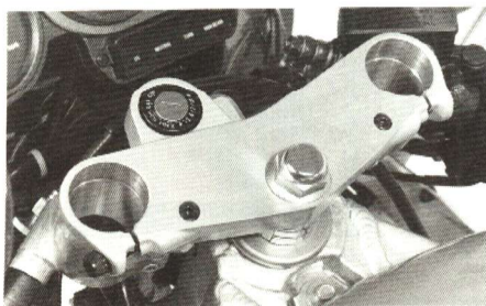
フォークオイルはフォークボルトを抜いた口から注入する。量と左右のバランスには特にシビアに
