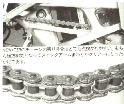
シールチェーンは手入れをおこたるとOリングが固着してコマ間がガタガタになってしまう。洗浄は水中中性洗剤で。結晶油SAE30~50のモーターオイルを用いる事
