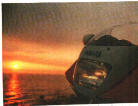
60w/55wの異形ハロゲンヘッドランプはスラントノーズフロントカウルに合わせて採用
