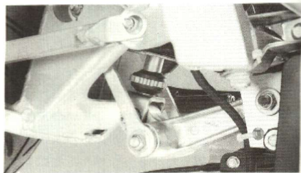
対してサス下部（スイングアームより下側）にはダンピングフォースを可変させられる伸側の減衰力調整ダイヤルがある
