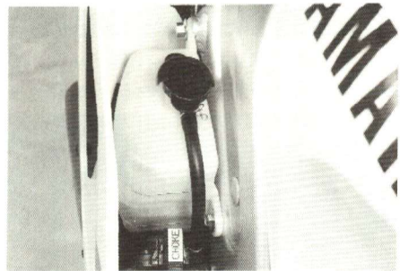
ライダー視線から見た冷却水のリカバリータンク。補水の際はFULLレベル以上に注入しないように気をつける
