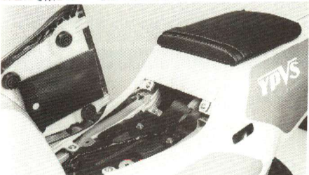
シート部のストリップ状態。自慢の後方排気チャンバーを見なければ、左右のサイドカバーとテールカバーを外す必要有
