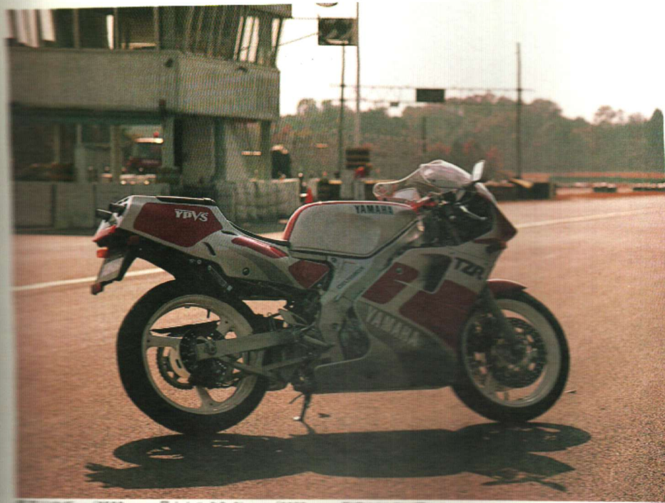
最高速は274km/h/9500rpm、最大トルク3.8kg-m/8000rpm、数字だけでは測れないモノをこのマシンは持っている
