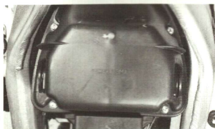
フェューエルタンクを完全に取り外すと現れるエアクリナーケース。ビスは落下に注意して外すように。
