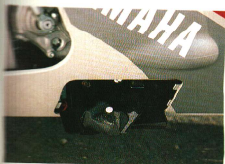
空気抵抗によって狭まれたシート下のスペースは、カウル下部に確保された
