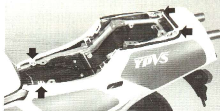
サイドカバー組み付け時にはテールカバーと合わせ目を確実に引掛ける事。折れやすいので注意してもらいたい
