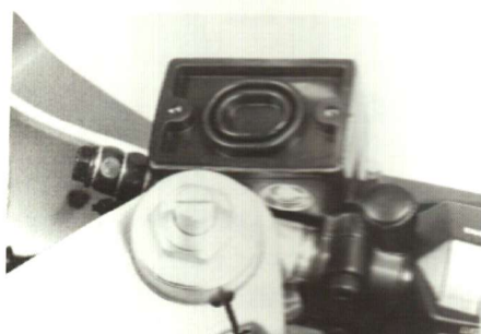
これはフロントのリザーバータンクキャップを外した状態。このダイヤフラムが液面の低下によって凹み、エアの混入も
