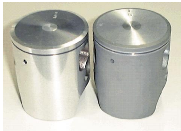
図6 WPC 処理ピストン右：2003 年モデル
